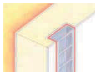
Incollaggio di guide fermacarico con Körapur 140
