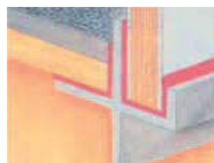
Applicazione del sigillante con Körapur 125
